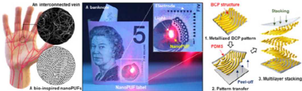
무작위 형태의 블록공중합체 자기조립 패턴을 적층하여 지문 모양의 나노 패턴의 형성 과정을 보여주는 모식도. 사진=KAIST 제공
