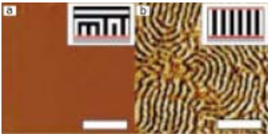
그림 4. P(S- b -PMMA) thin film의 morphology. (a) 기질 표면에만 중성표면 처리를 한 경우, (b) 기질표면과 공기와의 계면 모두에 중성표면처리를 한 경우(scale bar : 1 \mu m). 11
